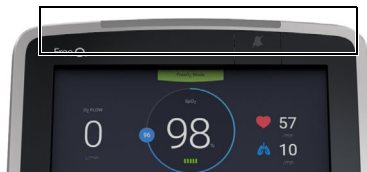
Figure 6-10 Témoin lumineux d'alarme
