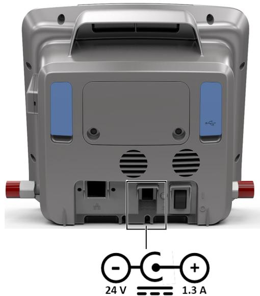
**Abbildung 4-1 Stromversorgungsanschluss**
